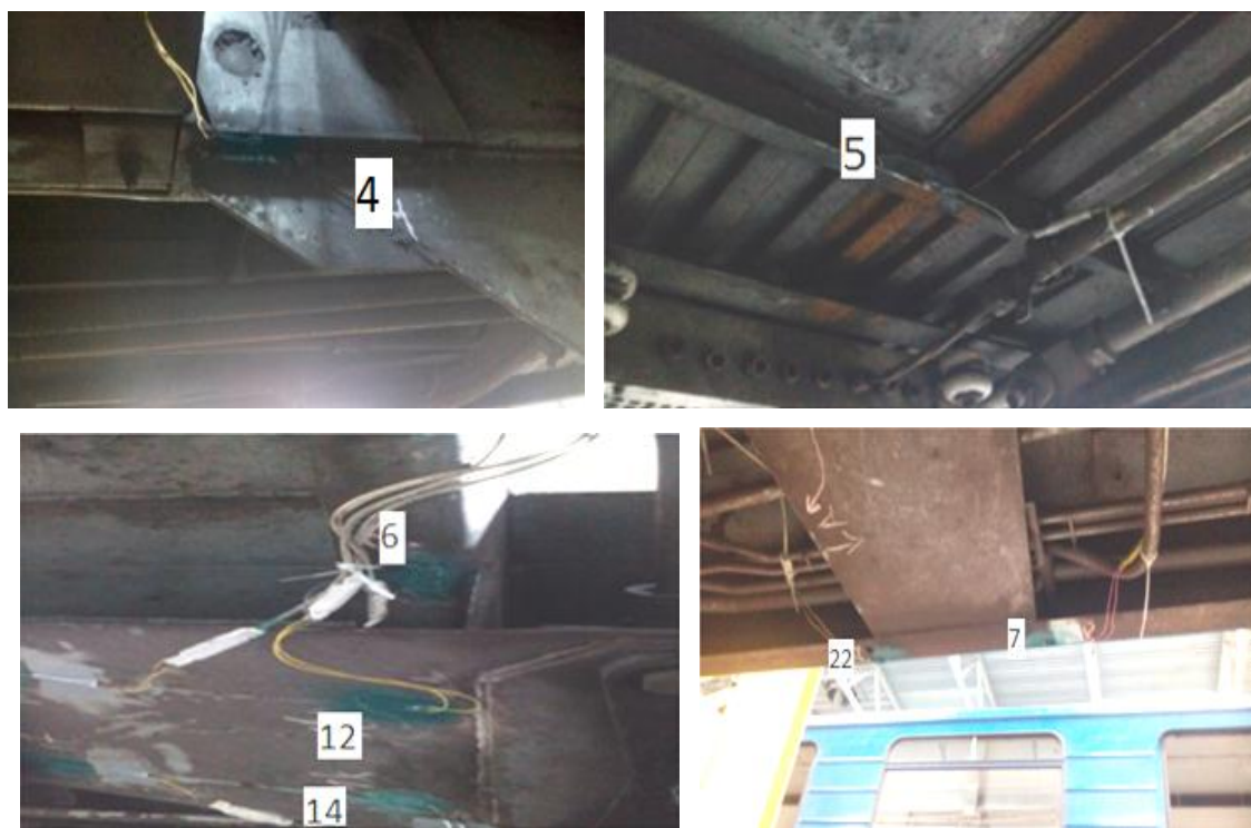
Рис. 5 – Фрагменты расположения тензодатчиков на металлоконструкциях вагонов модели 81-717/714
