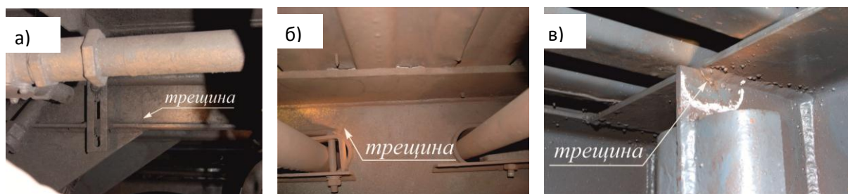
Рис. 2 – Эксплуатационные повреждения элементов несущих конструкций вагонов моделей 81-717 и 81-714: а) – трещина в хребтовой балке в районе крепления сцепного устройства; б) – трещина в вертикальном листе шкворневой балки; в) – трещина кронштейна крепления подвески автосцепки
